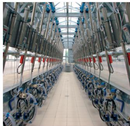
(Russia) Tipo de sala: 2x20 (40) Línea baja Amarre: Espina de pescado Medición electrónica y retirada automática Operarios: 4 Tiempo de ordeño: 5:30 h (800 vacas)
