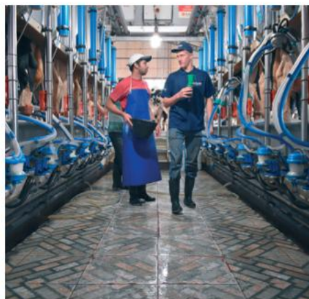
(Paraguay) Tipo de sala: 2x8 (16) Línea baja Amarre: Salida rápida Medición electrónica y retirada automática Operarios: 3 Tiempo de ordeño: 0:45 h (72 vacas)
